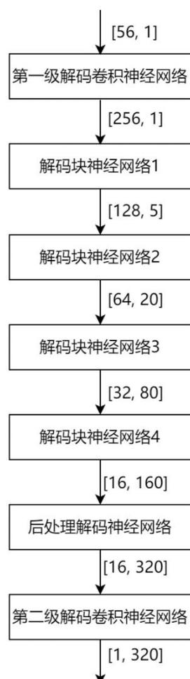
图9 宽带解码神经网络结构图
